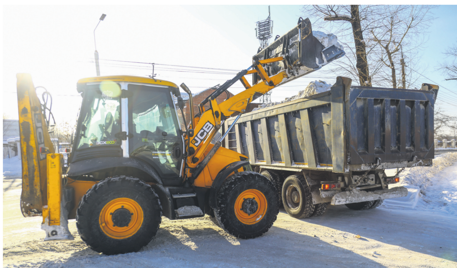
Классический комплекс «Иркутскавтодора» для работы на дороге — погрузчик и самосвал. К нему, разумеется, «прилагаются» два водителя, а еще один-три уборщика территорий с лопатами. В кузов входит около 25 тонн снега! Как только он заполняется, машина отправляется на снегоотвал
