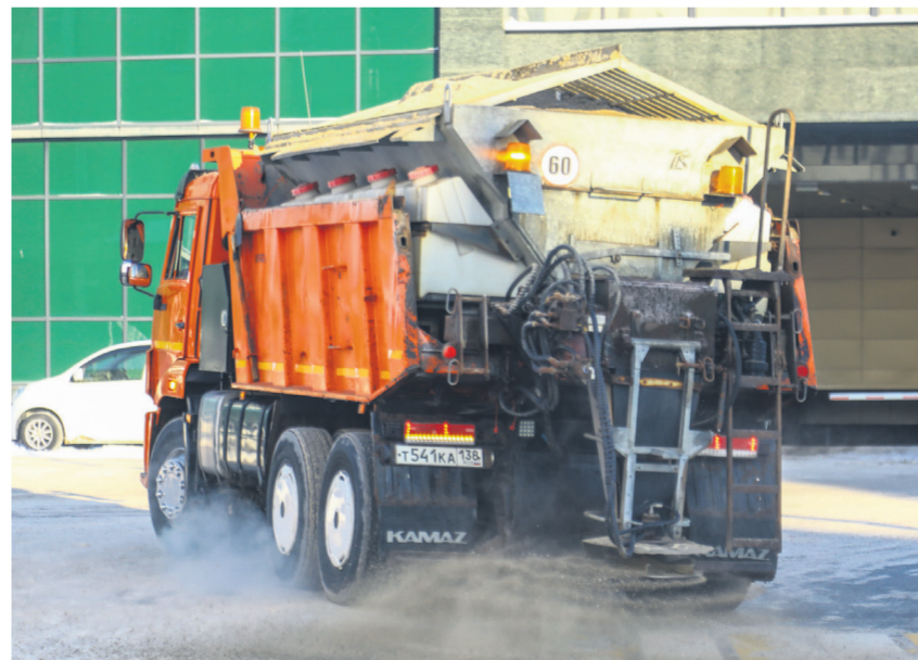
Перед нами — комбинированная дорожная машина на базе КамАЗа и ее установка распределения противогололедной смеси в действии. Специальный отсек техники наполнен отсевом, который установка разбрасывает по проезжей части
