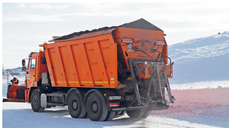
Зимой дорожно-коммунальные машины оснащают бункерами, механизмами распределения противогололёдного материала и снегоочистным отвалом
